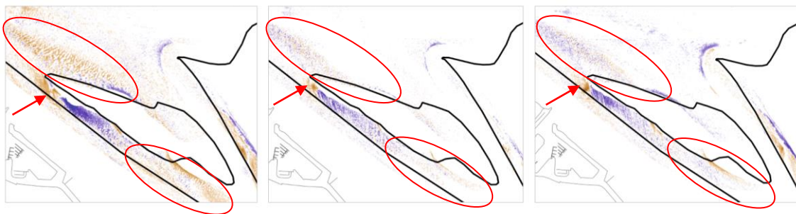
Figuur 5-1: Sedimentatie en erosie rondom het Plaatje van Breskens tussen T54-T55 (links), T55-T56 (midden) en T56-T57 (rechts).
