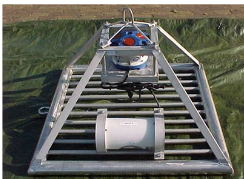
Figuur 3 ADCP geplaatst in meetframe
