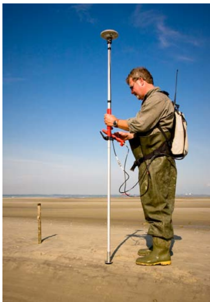
Figuur 2` : RTK meting bij een sedimentatie/erosie punt
