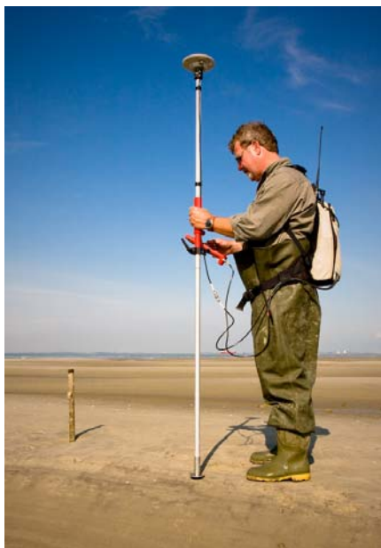
Figuur 2` : RTK meting bij een sedimentatie/erosie punt
