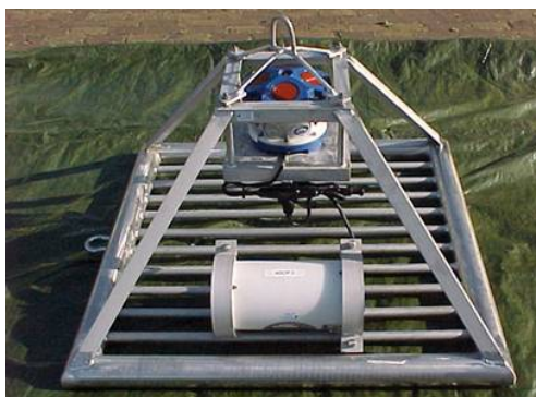
Figuur 3 ADCP geplaatst in meetframe
